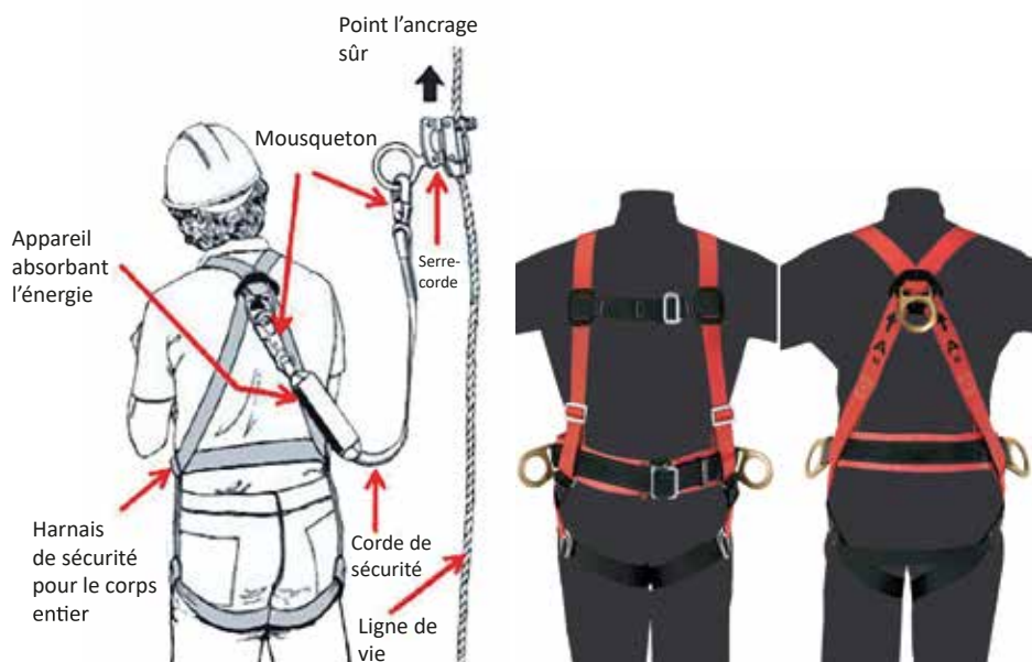
Utilisation du système d'arrêt de chute
